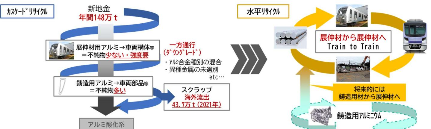
図2 アルミニウム車体の水平リサイクルの実現イメージ
